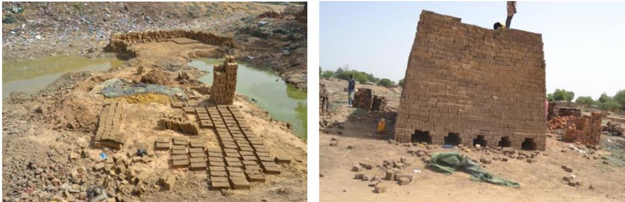
Image 1: Fabrication des briques en terre crue et dispositif de four en auto-combustion/ Source : Enquête de terrain
