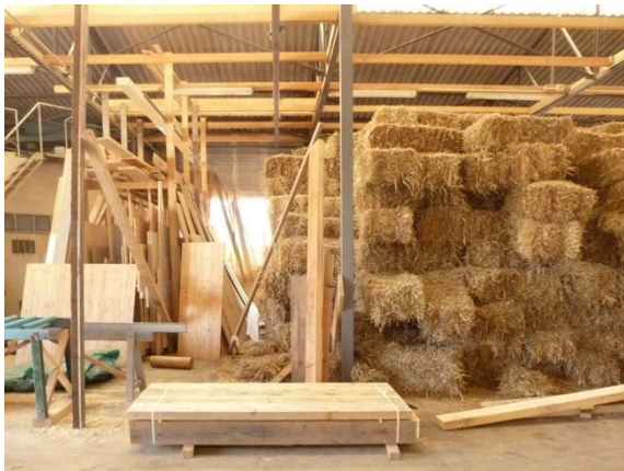
Figure 21: Vue du stock de paille dans l'atelier du charpentier Sertelet pour la construction de la Ruche de Tendon, 2011 (© Haha).
